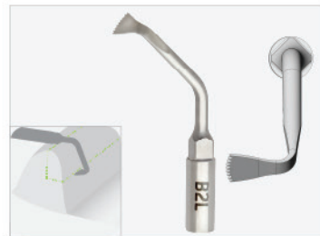
B2R, B2L Mũi cắt lưới của cho phép cắt theo mặt phẳng ngang, ít mất xương, dành cho vùng khó tiếp cận. Có sẵn loại mũi khuỷu bên phải hoặc khuỷu bên trái.
